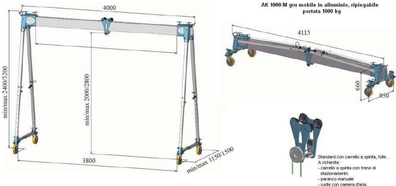
I montanti di supporto sono ripiegabili, questo permette di abbassare totalmente la gru, sfruttando così le proprie ruote come carrello di se stessa.
