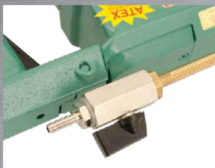
Regolatore di avanzamento con ugello e valvola attacco acqua
