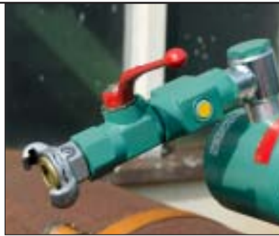
Valvola di comando con pulsante di sicurezza antiavviamento involontario
